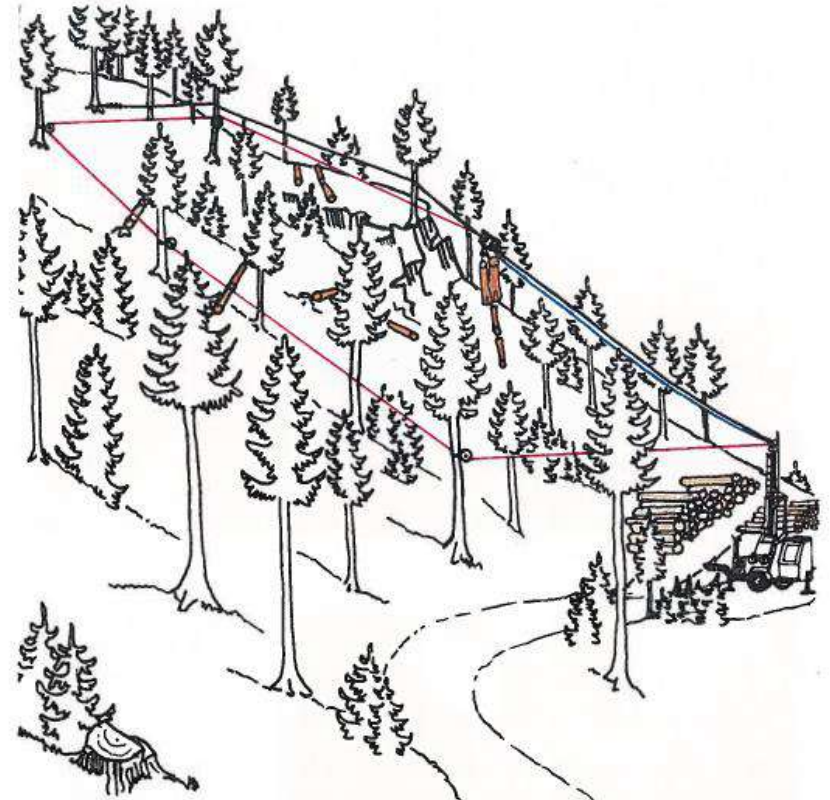
Rappresentazione schematica del trasporto a valle con la teleferica mobile
